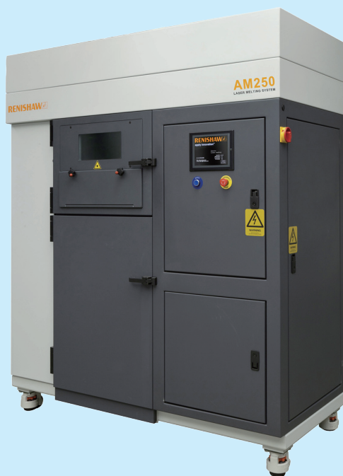
雷尼绍AM250激光熔融快速成型机
